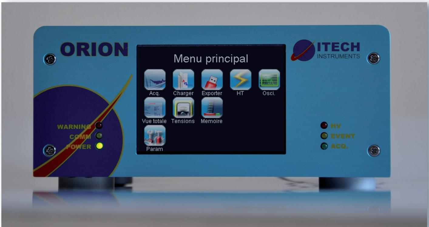
L'**ORION** est l'état de l'art des analyseurs de spectrométrie numérique. Il est entièrement développé par **ITECH INSTRUMENTS**. C'est un analyseur 100% numérique avec 64K canaux de mémoire. L'**ORION** est équipé d'un ADC de 16 bits avec une fréquence d'échantillonnage de 80 MHz et d'un ordinateur interne avec le système d'exploitation Linux. Il intègre la haute tension et traite les données acquises selon les modes : « PHA, List et Pulse shape ».
