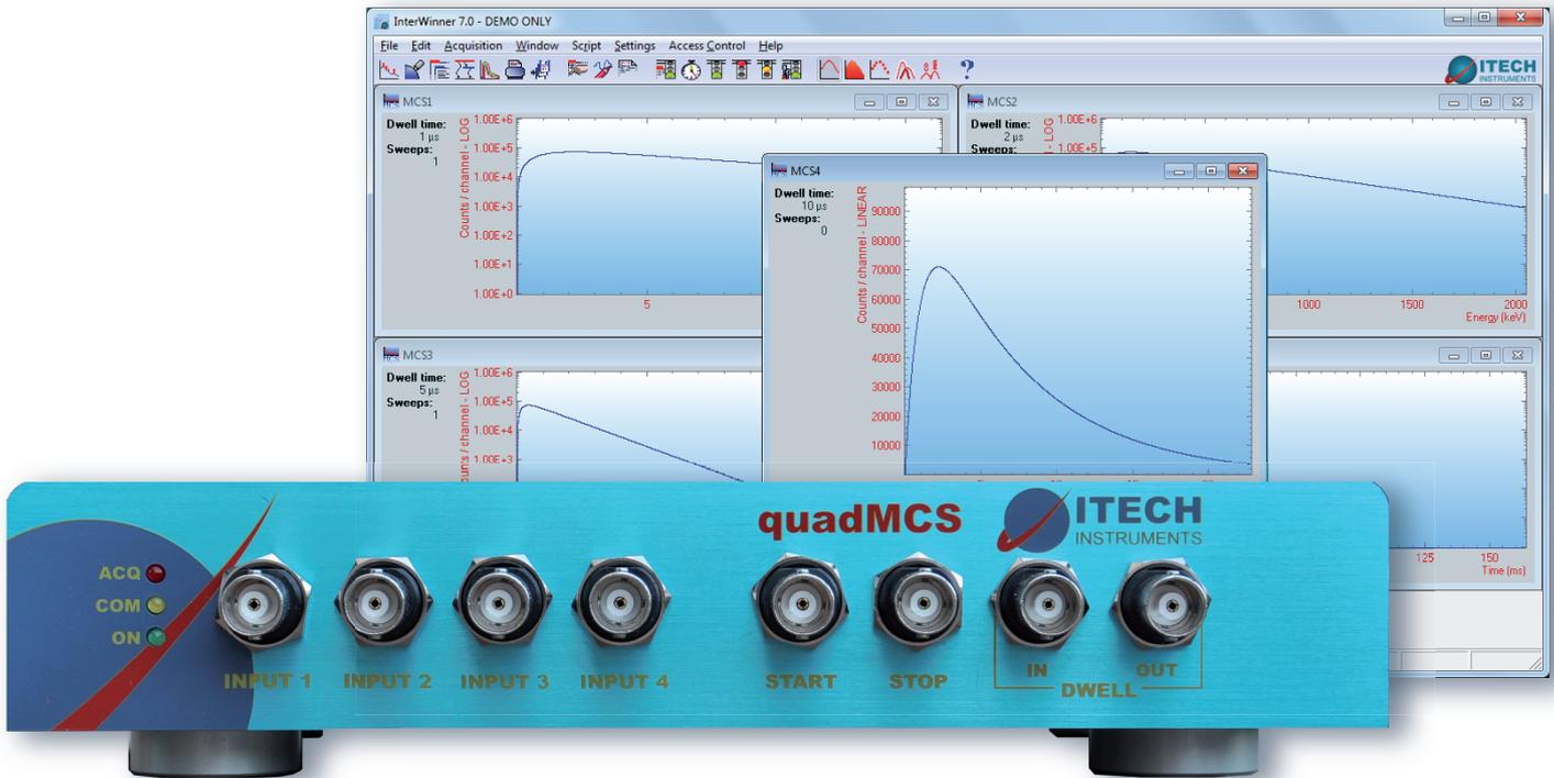
Le **quadMCS** est un module multi-échelle rapide à quatre entrées. Il dispose de 128k canaux par entrée et peut être contrôlé par ordinateur via une liaison USB ou Ethernet. Une Sortie analogique et des entrées/sorties numériques sont disponibles pour contrôler des appareillages périphériques.
